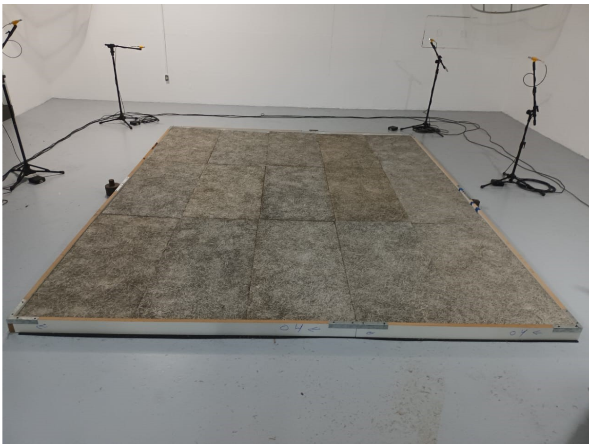
Figura 3: Amostras Forrofort Acoustic - 18 mm + Ecofiber Sound - 50 mm - 20 kg/m 3 enclausuradas e posicionadas na câmara reverberante.
